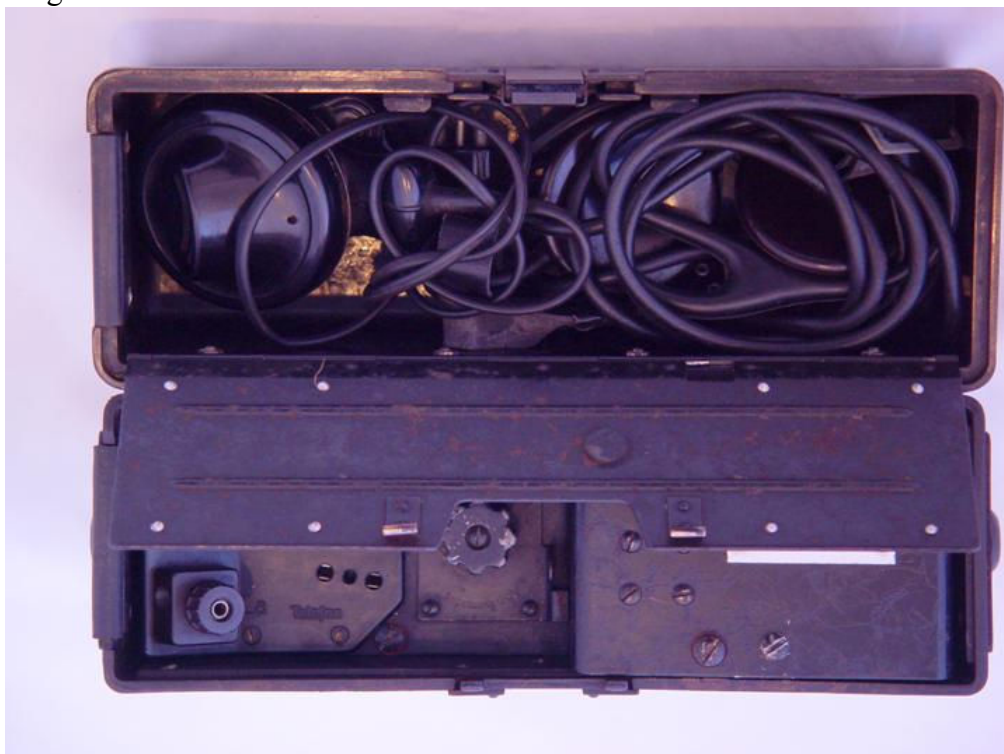
Figure 51: Erdsprechgerät storage in lid for headset and microphone
