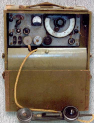
Первые УКВ ЧМ радиостанции А-7 диапазона 27-32 МГц были испытаны в конце 1942 г. Серийное производство началось в 1943 г. на заводе №2 Наркомата обороны, занимавшем цеха эвакуированного в Саратув московского радиозавода №203.
