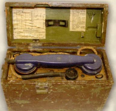
**УНА-И-43** — полевой телефон образца 1943 г. Унифицированный аппарат с питанием от местной батареи сухих элементов напряжением 3 В и с индукторным вызовом. Завод № 628, г. Уфа. Начало выпуска — 1943 г.
