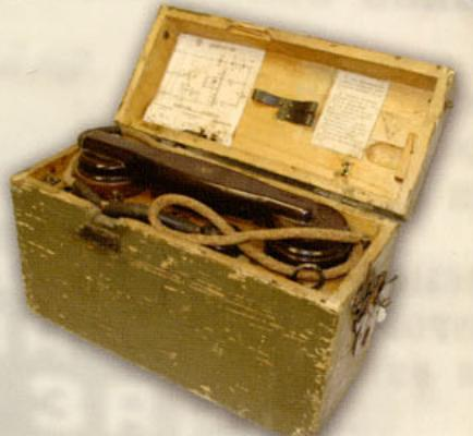
**УНА-И-42** — полевой телефон образца 1942 г. Унифицированный аппарат с питанием от местной батареи сухих элементов напряжением 3 В и с индукторным вызовом. Завод № 628, г. Уфа. Начало выпуска — 1942 г.
