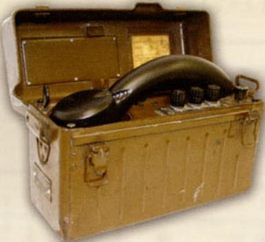
**ТАБИП-1** — полевой телефон образца 1941 г. Телефонный аппарат без источников питания работает за счет энергии голоса говорящего. Дальность связи с использованием аппаратов ТАБИП могла достигать 5 км при использовании полевого телефонного провода или 20 км при использовании воздушных телефонных линий. Завод "Красная Заря", г. Ленинград. Начало выпуска — 1941 г.
