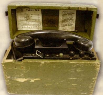
**ТАИ-43** — полевой телефон образца 1943 г. Аппарат с питанием от местного сухого элемента напряжением 1,5 В и с индукторным вызовом. Завод "Красная Заря", г. Ленинград. Начало выпуска — 1943 г. В годы войны ТАИ-43 выпускались в деревянных корпусах.
