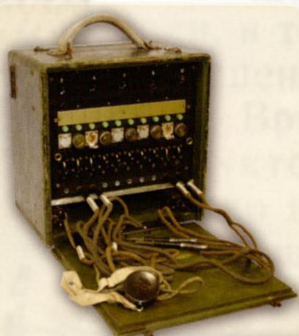
**ПК-10** — полевой коммутатор на десять абонентов. К ПК-10 могли подключаться до пяти полевых телефонов с фоническим вызовом и до пяти телефонов с индукторным вызовом. Два коммутатора ПК-10 могли объединяться, образуя поле на 20 абонентов.
