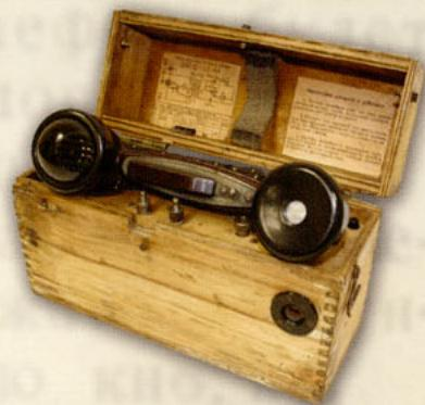
**УНА-Ф-42-М** — полевой телефон образца 1942 г. Унифицированный аппарат с питанием от местной батареи сухих элементов напряжением 3 В и с фоническим вызовом. Аппараты УНА-Ф позволяли вести по телефонным линиям не только голосовую, но и телеграфную связь. Завод № 629, г. Молотов. Начало выпуска — 1942 г.
