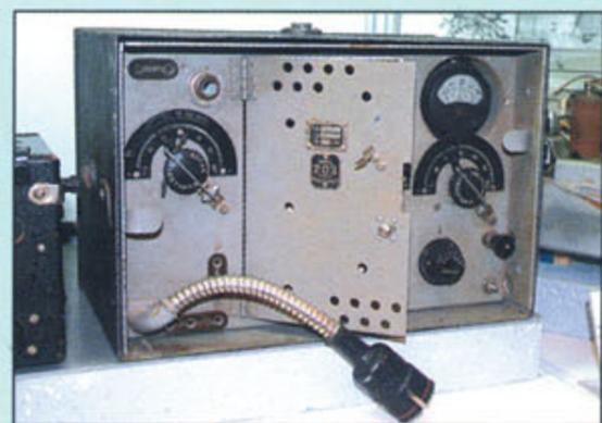
Полудуплексная радиостанция 12-РП использовалась для работы на ходу или на стоянке в радиосетях стрел-
