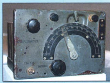
ковых и артиллерийских полков. Ее рабочий диапазон частот — от 2 до 6 МГц. Передатчик радиостанции двухкаскадный, приемник (выпускался отдельно как 5СГ-2 и 5СГ-3) — это пятиламповый супергетеродин. Выходная мощность около 0,5 Вт. Питание от батарей БАС-60 и аккумуляторов.
