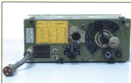
Приемник УС — восьмилламповый всеволновый супергетеродин, предназначенный для приема телеграфных и телефонных сигналов. Диапазон рабочих частот от 0,175 до 12 МГц был разделен на 5 поддиапазонов.
