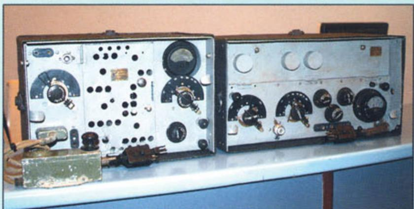
(позднее — 71ТК-3) — двухкаскадный, с выходной мощностью 20 Вт. Диапазон частот — от 4 до 5,625 МГц. Приемник 71ТК-3 — это семиламповый супергетеродин на лампах прямого накала. Питание радиостанции осуществлялось от аккумуляторов и умформеров РУН-10 и РУН-75Б.
