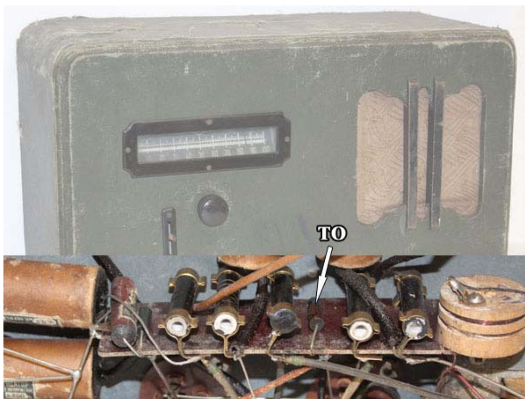
Рис. 6. Сопротивления Каминского и ТО в батарейном приемнике РПК-10
