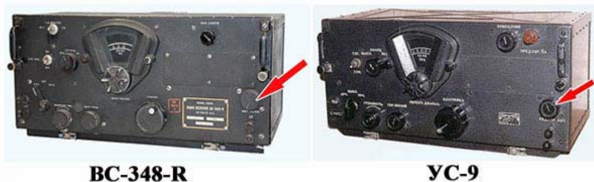
Рис. 9. Первый вариант советского приемника УС-9, появившийся в 1946 году, в точности повторял американский приемник BC-348-R образца 1943 г.
