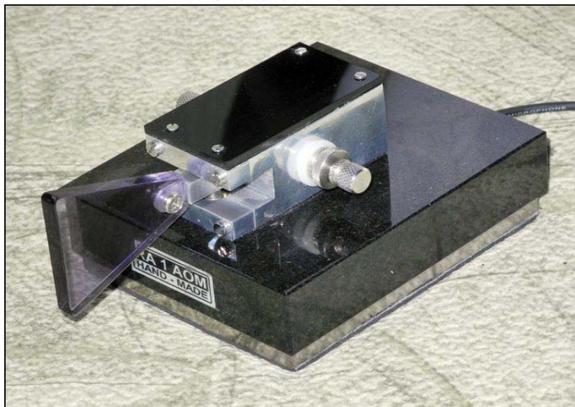
Новая модель Павлова В.Г. / RA1AOM - манипулятор типа "single" электронного ключа. Магнитная система демпфирования практически полностью исключает «отскок», приводящий к ошибке в передаче. В качестве основания манипулятора использован редкий минерал габбро.
