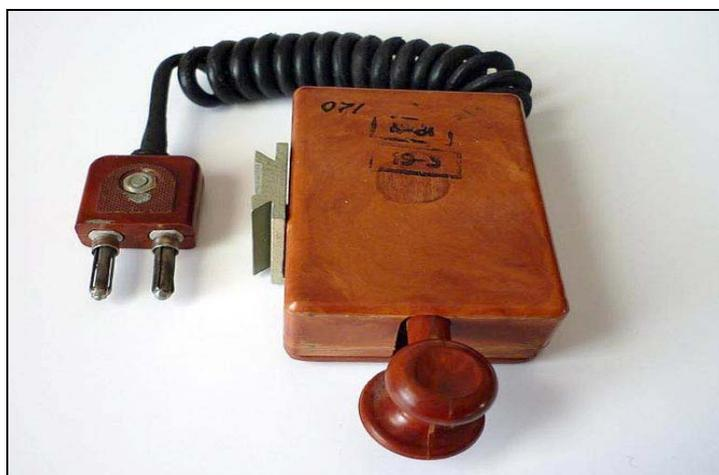
Малогабаритный ключ, входящий в комплект радиостанций спецназа Р-393 и других. Существует две модификации такого ключа, отличающиеся способом его крепления в укладочном кейсе – винтом или ползком с зажимом.
